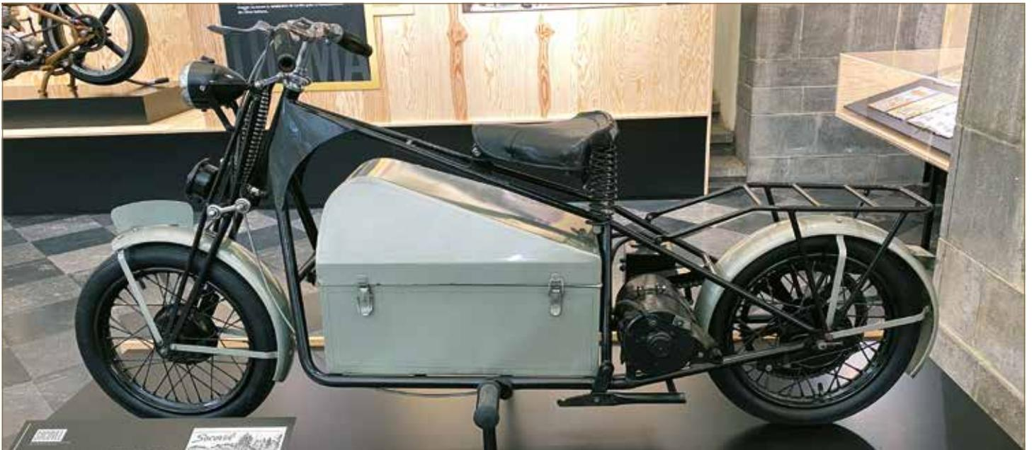
▲ Socovel, moteur électrique 45 Ah, 1941. Une pénurie d'essence oblige les constructeurs à se tourner vers l'électricité. Le modèle de moto le plus abouti est la Socovel des frères Limelette. Ce modèle pèse 75 kg, possède une autonomie de 50 km pour une vitesse maxi de 25 km/h. Les 3 batteries de 6V se rechargent en 10 heures. 500 ex furent produites jusqu'en 1943
