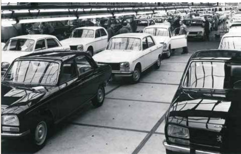
▲▲ Au contrôle final, chaque voiture était scrupuleusement inspectée pour les défauts techniques, les dégâts de carrosserie et l'étanchéité. La Peugeot 404 fut longtemps assemblée à Malines
